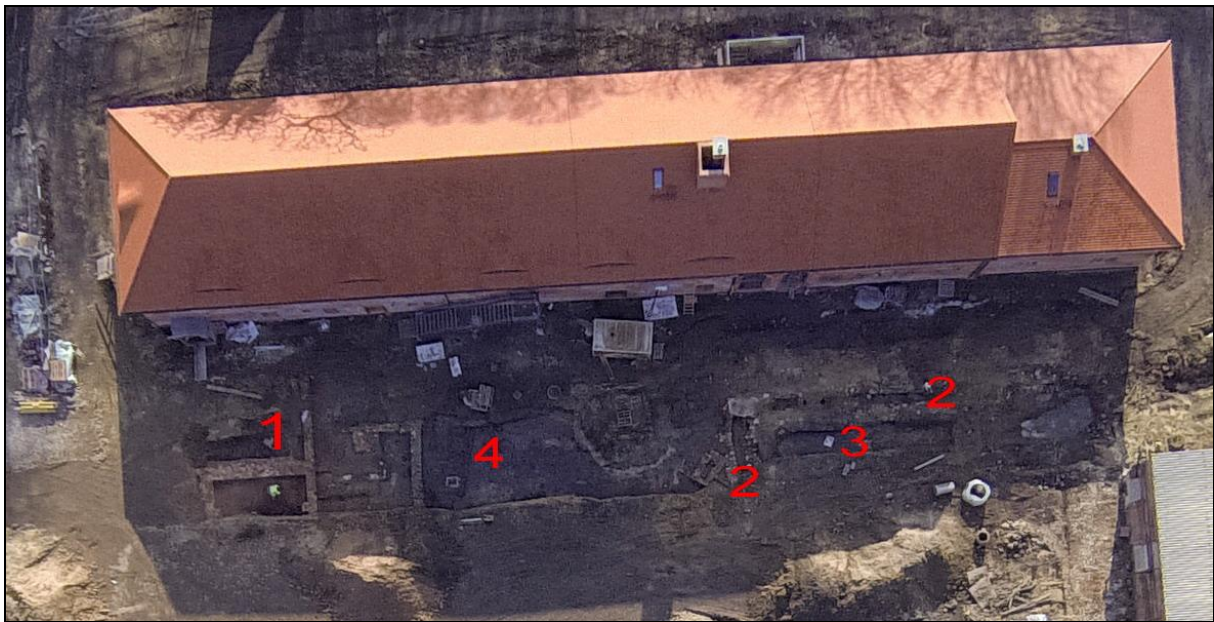
1 Grundmauern des ehemaligen Amtshaus 2 Freigelegter Braukanal 3 so genannte Schlamp-Kuthe 4 Holz-Wasserleitung (links neben der 4) Im Hintergrund das neu hergerichtete Brauhaus mit dem westlichen Anbau (rechts) © G+P 27.02.2015
